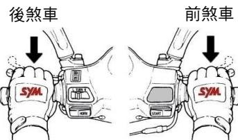
3. 按電動起動按鈕時，有按住後煞車或前煞車嗎？
